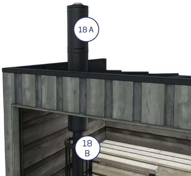
11. Pujota teräspiippu ( 18 A ) eristevillan ja katon lävitse. Laske teräspiippu savuputken ( 18 B.) päälle.
